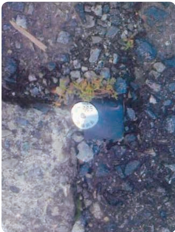
地籍調査ピン打ち (高池下部)
